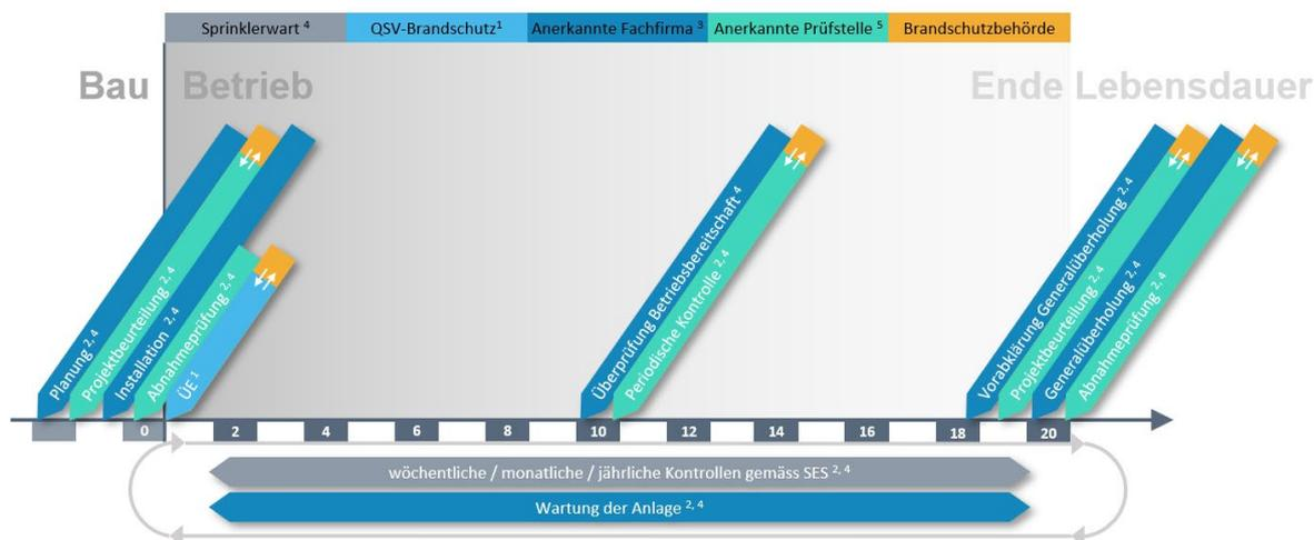
Abbildung 3: Nötige Meilensteine für Planung und Betrieb von Sprinkleranlagen (SPA)
