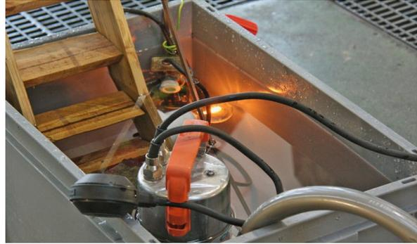
Simulation: Eine mit Wasser gefüllte Kunststoffbox eignet sich für die eindrückliche Demonstration der Gefahr einer Spannungsverschleppung in einem überfluteten Keller.
